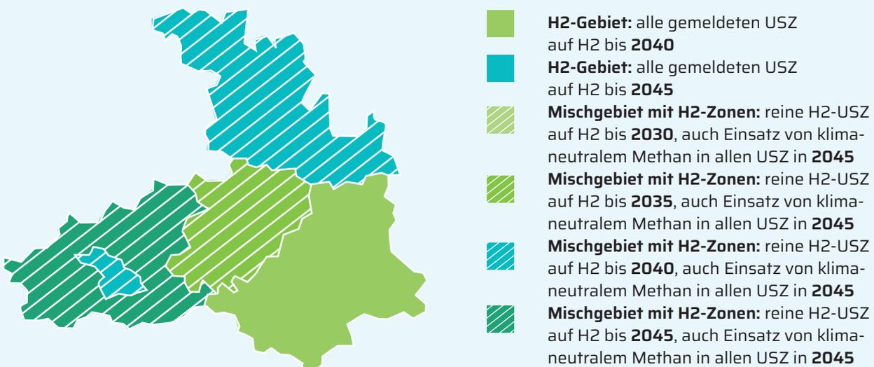
**Abbildung 5:** Zielzustande der Gasverteilnetze in Heilbronn-Franken. Die Abbildung zeigt die Kreise der Region und unterscheidet zwischen reinen Wasserstoff-Umstellzonen (USZ) und Mischgebieten mit Wasserstoff- und Methaneinsatz. (Abbildung: GTP 2024 [7]).
